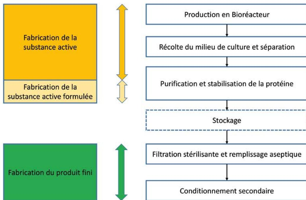
*Répartition des étapes de fabrication au sein d'un procédé de produit biologique dans lequel la formulation est réalisée en cours de purification*
