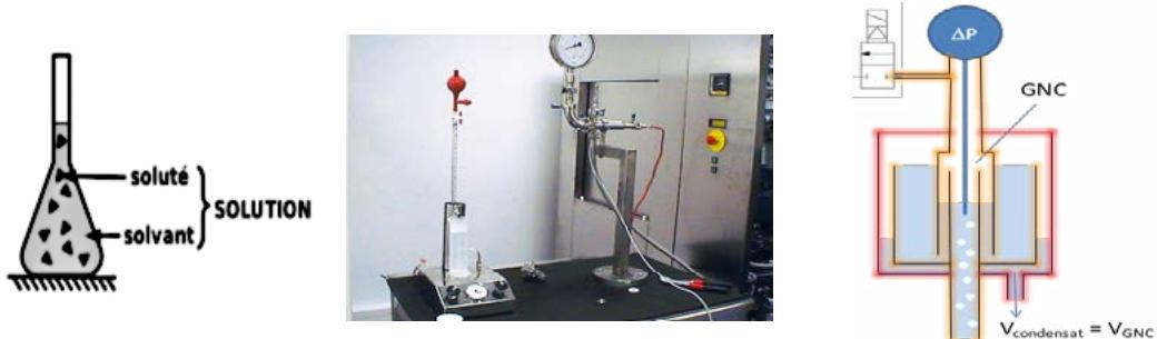
Alors concentrons-nous sur un détail : quid de la concentration de **Gaz Non Condensables\*** (**GNC**) dans la vapeur d'eau ? Que l'on calcule en masse ou en volume (cf Fig.1), le résultat étant un rapport sans unité, on l'exprimera comme un taux.
