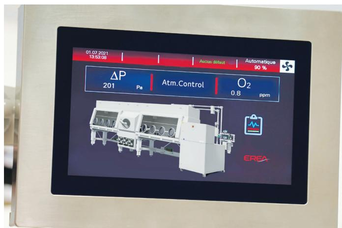
L'écran tactile (IHM) sur un isolateur fonctionnant sous gaz neutre permet un contrôle continu des paramètres critiques, oxygène en particulier.
