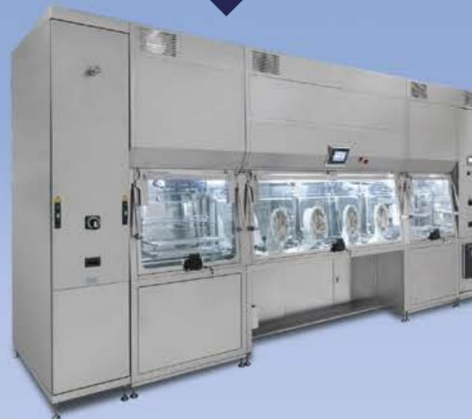
Isolateurs pour les process aseptiques ou le confinement, équipements automatiques de test d'intégrité des gants, chambres de bio-décontamination actives pour transfert aseptique ainsi que tous les accessoires et services associés.
