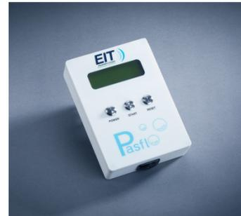
**Pasflo™** mesure le débit pour les applications de surveillance du flux de liquides. Son capteur à haute sensibilité et son interface intuitive vous permettent de suivre avec précision les variations de débit dans des systèmes critiques, assurant ainsi un contrôle rigoureux des processus industriels.
