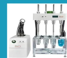
Système de surveillance UV par fibre optique in situ Rainbow. Conçu pour des volumes de milieux biopertinents de 100 à 250 ml. Idéal pour mesurer de faibles concentrations sont attendues.
