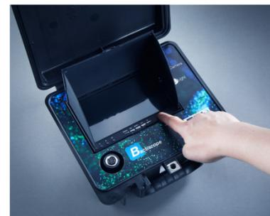
**Bactiscope** est microscope portable spécialisé pour l'inspection microbiologique in situ. Doté d'un système optique avancé, il permet d'observer directement les microorganismes sur les surfaces sans nécessiter de prélèvements complexes
