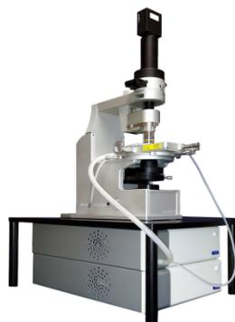
Le Lyostat 5 identifie les températures d'effondrement/eutectique, les phénomènes de cristallisation, le potentiel de formation de peau/croûte et les effets du recuit sur la croissance des cristaux de glace et la structure du soluté. Vidéo numérique en temps réel et mesure : à l'aide d'une caméra USB numérique haute performance pour déterminer le point exact d'effondrement, capturez jusqu'à 80 Go d'informations.
