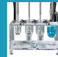
Plateforme analytique in vitro pour les mesures de dissolution et de flux de formulations à dose entière utilisant des volumes biopertinents
