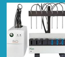
Système de surveillance UV à fibre optique in situ pour petits volumes de 2 à 20 ml. Évalue la solubilité, le taux de dissolution intrinsèque du disque, les profils de dissolution, la sursaturation et les modèles de précipitation
