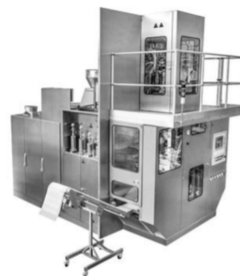
↑ Figure 2 : Machine de conditionnement d'unidoses stériles, nommée BottelPack, ©Rommelag
